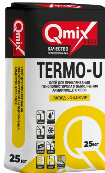
Расход клея зависит от степени ровности основания и способа нанесения. Во время выполнения работ по утеплению необходимо следовать строительным правилам и нормам, а также инструкциям по выполнению систем теплоизоляции. К дополнительному креплению плит тарельчатыми дюбелями и созданию армирующего слоя можно приступить не ранее чем через 3 суток после их приклеивания.
